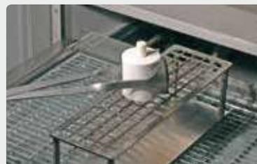
Al termine del programma di pressatura, con l'apposita pinza, prelevare il cilindro caldo e posizionarlo sulla griglia di raffreddamento, in zona priva di correnti d'aria, fino al raggiungimento della temperatura ambiente.
