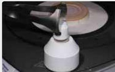
Inserire il IPS One-Way Plunger da 300 g **freddo** nel cilindro **caldo**.
