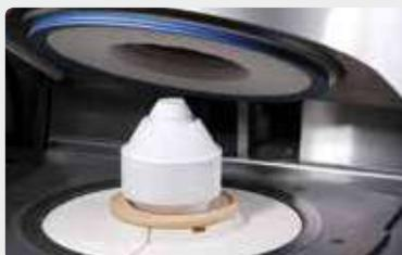
Con la pinza per cilindro, posizionare il cilindro completato e **caldo** al centro del forno per pressatura **caldo**.
