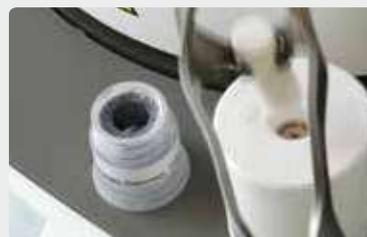
Infine inserire il pistone in allumina IPS Alox Plunger umettato con polvere nel cilindro **caldo**.
