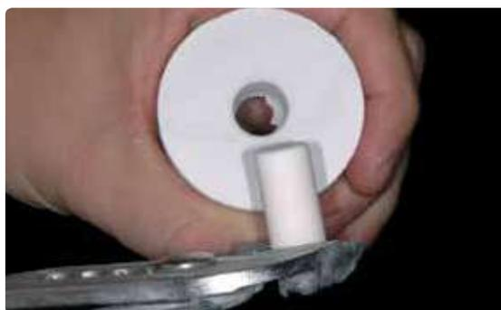
Ruotando leggermente il pistone in allumina con una pinza dal rivestimento è possibile estrarlo già pulito. In ogni caso controllare che sia pulito ed eventualmente sabbare con  $Al_2O_3$ .
