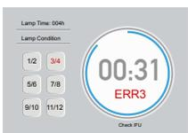
ERROR 3: se è presente una lampada difettosa, i numeri appartenenti alla lampada o alle lampade difettose diventeranno rossi sul display. Sul display verranno anche visualizzati l'errore ERR3 e il messaggio Check IFU. Al termine del tempo dell'operazione, sostituire le
