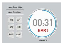
ERROR 1: nel caso in cui la temperatura intorno al reattore superi i 60 °C, la macchina si arresterà automaticamente e sul display verrà visualizzato l'errore ERR1.
