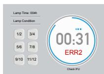
ERROR 2: nel caso in cui si verifichi un problema con i sensori della temperatura, la macchina si arresterà automaticamente e sul display verrà visualizzato l'errore ERR2. (contattare il distributore)
