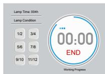
Avviare la macchina premendo il pulsante di avvio/arresto. Inizierà il conto alla rovescia e i puntini lampeggeranno. (Premendo il pulsante di avvio/arresto, il tempo dell'operazione verrà memorizzato automaticamente).
