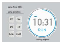
Quando sul display viene visualizzato il tempo dell'ultima operazione, l'utente può scegliere un tempo preimpostato tenendo premuto il pulsante programma, oppure ridurre o aumentare il tempo dell'operazione premendo il pulsante di riduzione o aumento.
