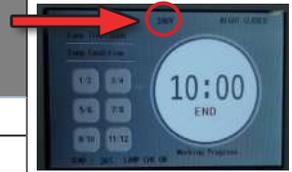
Dopo l'attivazione dell'unità, nell'angolo in basso a destra della schermata di benvenuto viene visualizzata la tensione preimpostata. La tensione verrà visualizzata anche nell'angolo in alto a destra della schermata principale.
