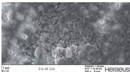
Fig. 81: Superficie della struttura dopo 12 ore di esposizione all'acido fluoridrico
