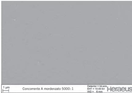
Fig. 54: Ceramica da rivestimento in ossido di zirconio senza struttura che impedisce le sollecitazioni e le incrinature.
