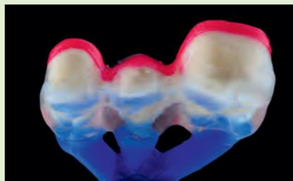
Fig. 67: Imperniare i fili di cera in direzione assiale incisale o occlusale, quindi pesare l'oggetto da pressare per calcolare il fabbisogno di ceramica per pressatura
