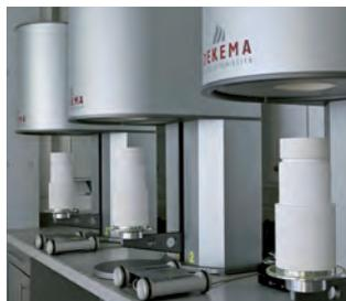
Fig 31: Le strutture vengono poi sinterizzate in forni ad alta temperatura.
