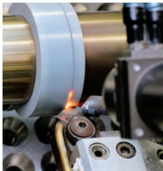
Fig. 36: Lavorazione a secco a livello industriale
